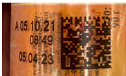
Печать кода маркировки на бликующей/светоотражающей поверхности
